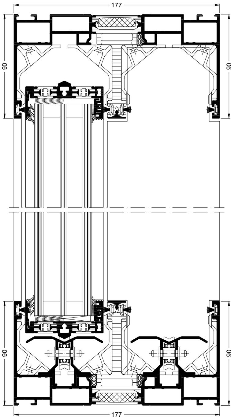
**Schüco ASE 67 PD als Typ 2A, Vertikalschnitt durch Schiebeflügel, rechts**
