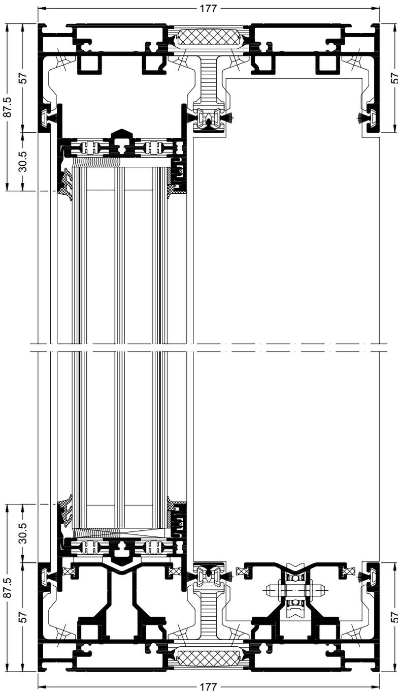
**Schüco ASE 67 PD als Typ 2A, Vertikalschnitt durch Schiebeflügel, rechts**
