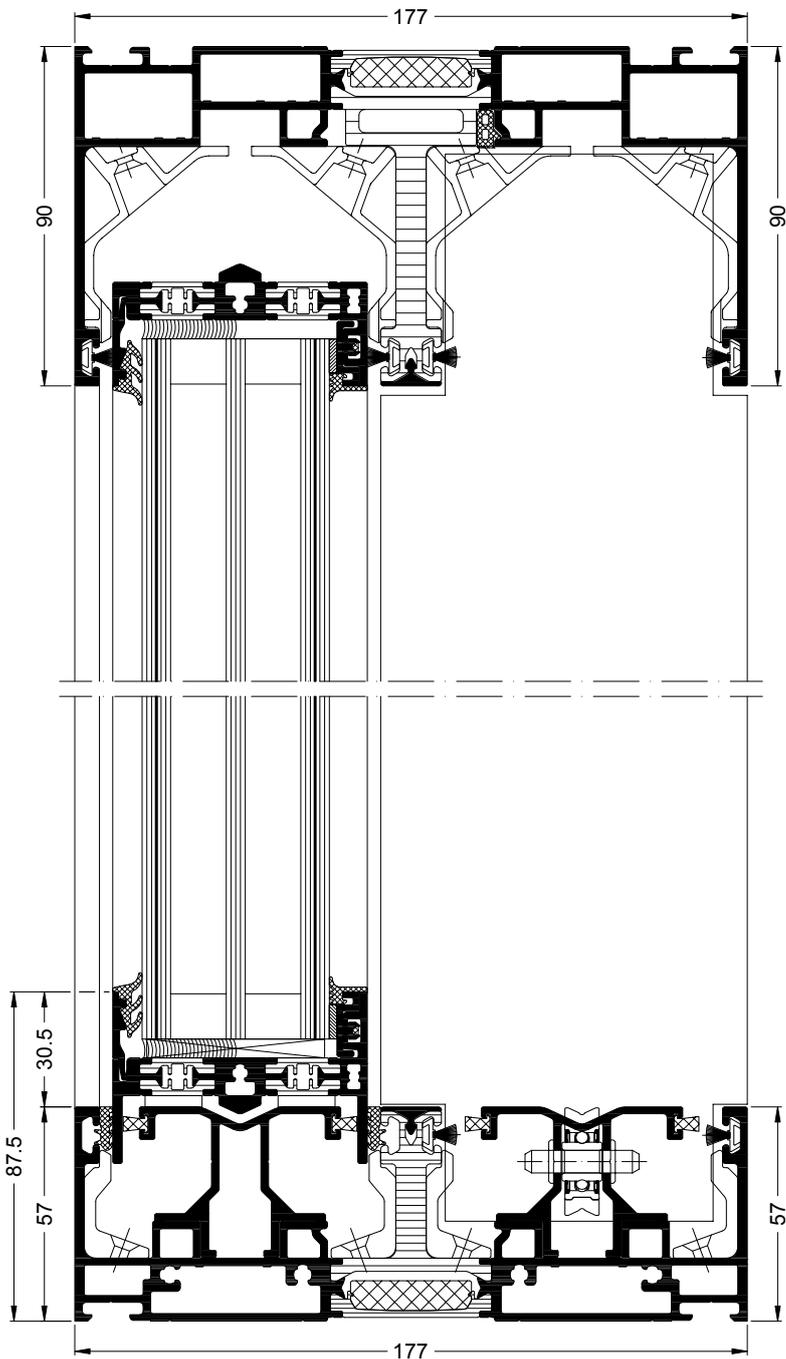
**Schüco ASE 67 PD als Typ 2A/1, Vertikalschnitt durch Schiebeflügel**
