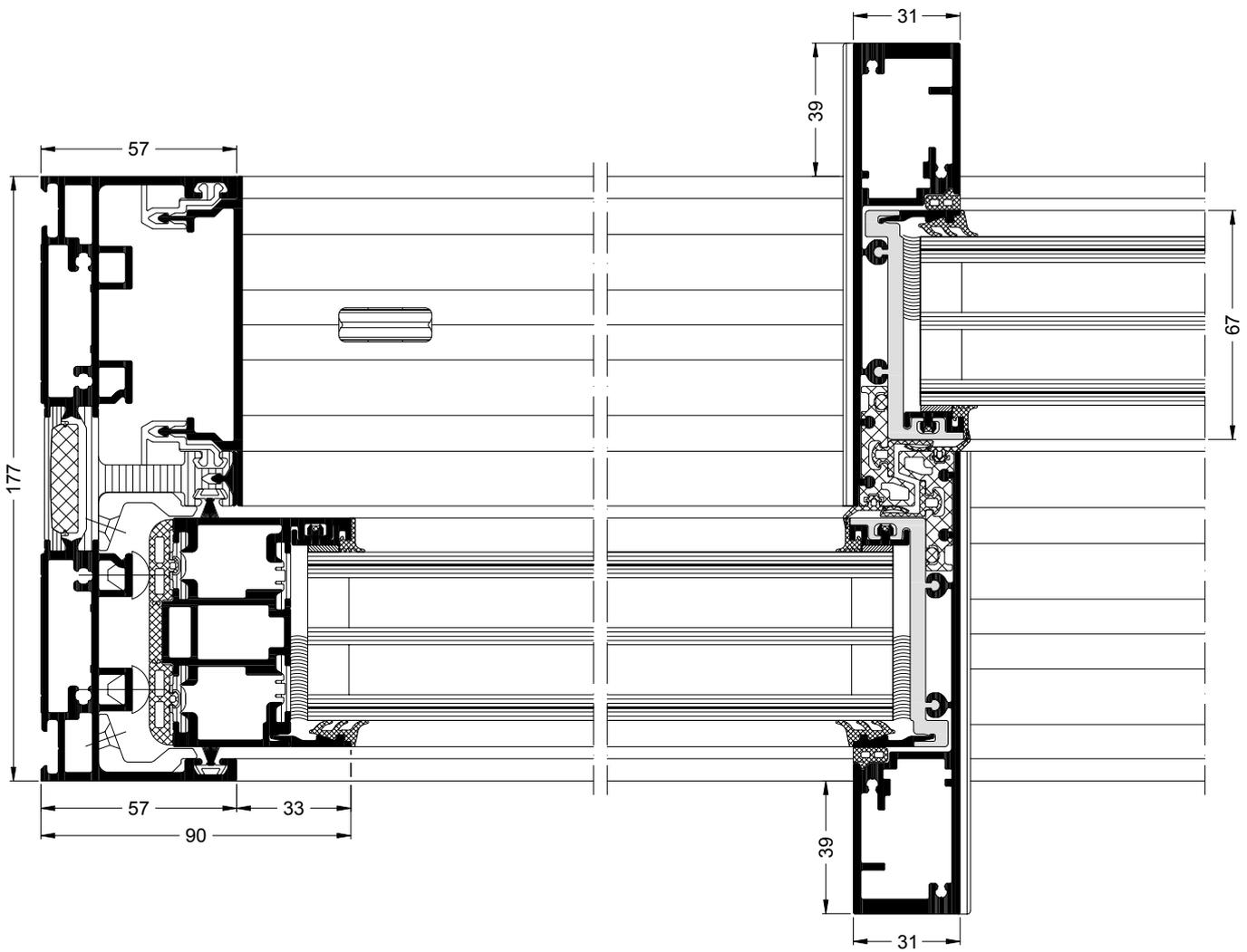
**Schüco ASE 67 PD als Typ 2A, Horizontalschnitt durch Schiebeflügel, rechts**
