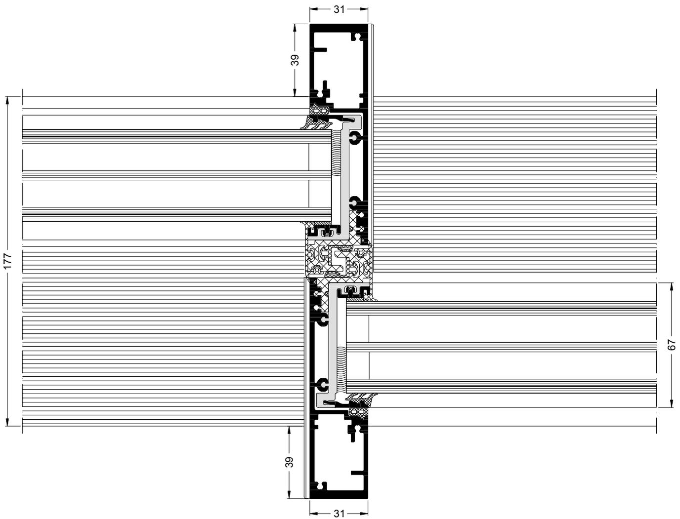
Schüco ASE 67 PD als Typ 2D, Horizontalschnitt durch Stulpflügel
