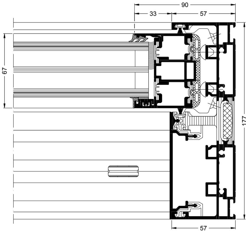
**Schüco ASE 67 PD als Typ 2A/1, Vertikalschnitt durch Festfeld**
