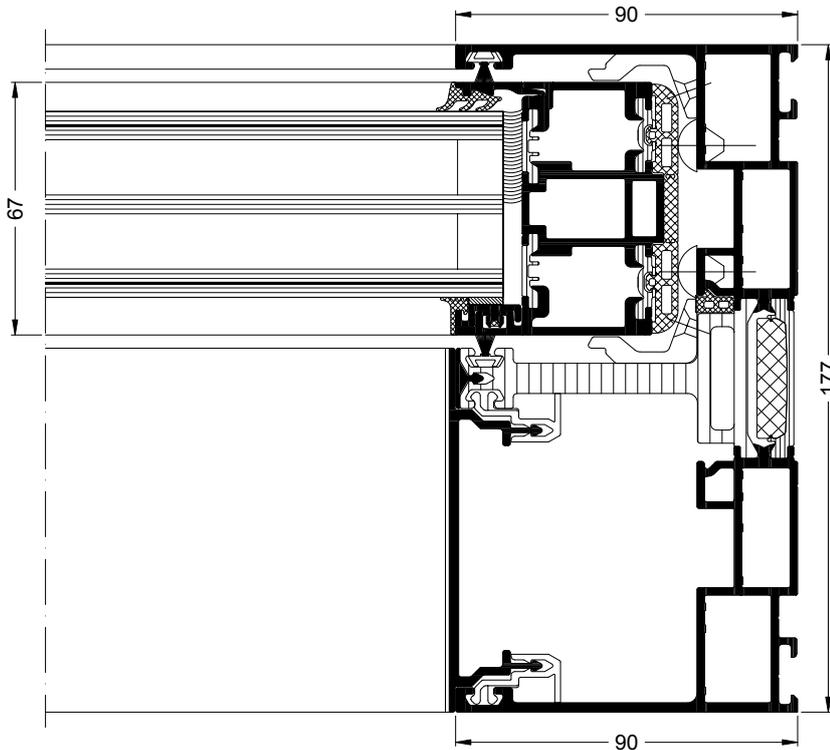
**Schüco ASE 67 PD als Typ 2A/1, Vertikalschnitt durch Festfeld**
