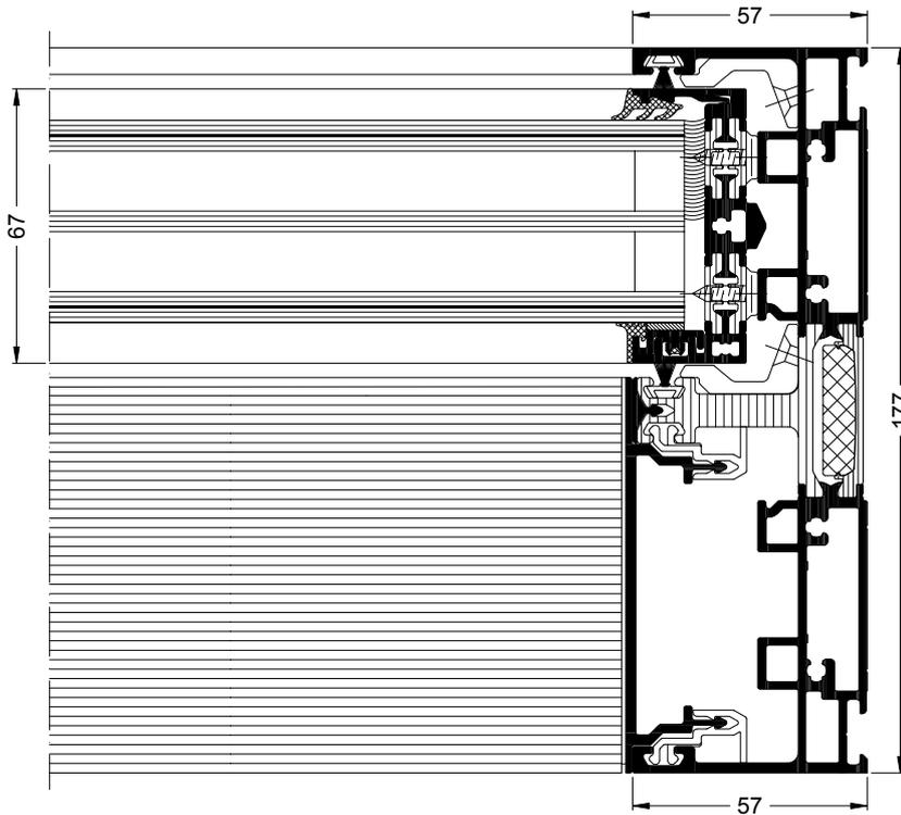
**Schüco ASE 67 PD als Typ 2A, Vertikalschnitt durch Schiebeflügel, links**
