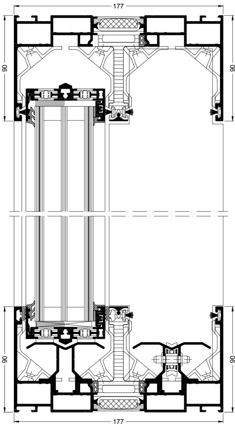
**Schüco ASE 67 PD als Typ 2A/1, Vertikalschnitt durch Schiebeflügel**
