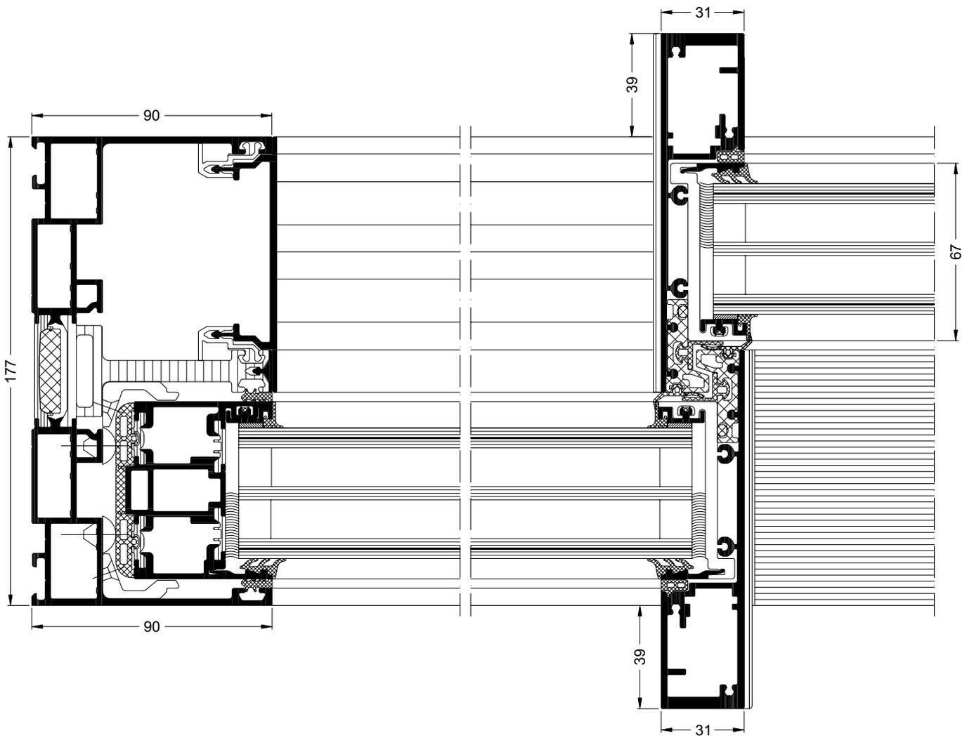
**Schüco ASE 67 PD als Typ 2A/1, Horizontalschnitt durch Schiebeflügel**
